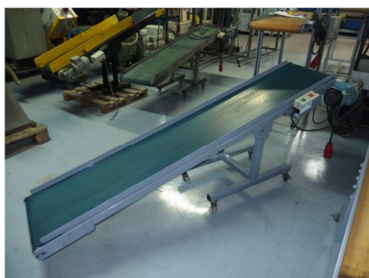
Cinta transportadora plana 2100x400 mm.
