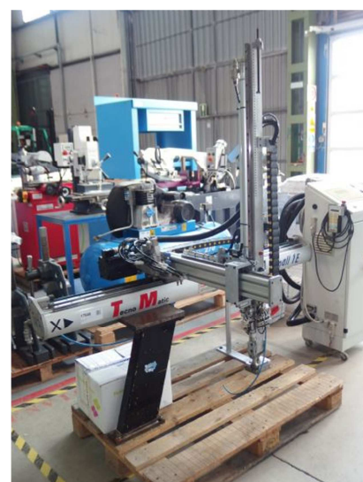
Robot cartesiano de hasta 250 toneladas.
