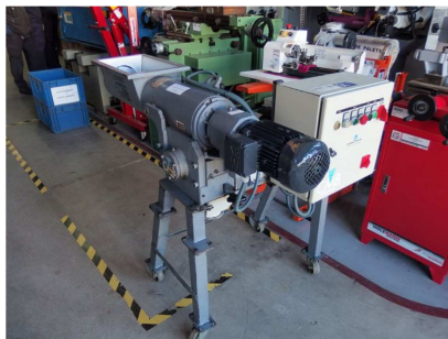
Molino compacto autoalimentado 2.2 kw
