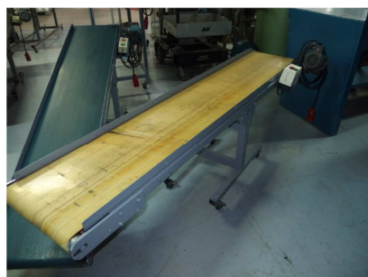
Cinta transportadora plana 2100x400 mm.
